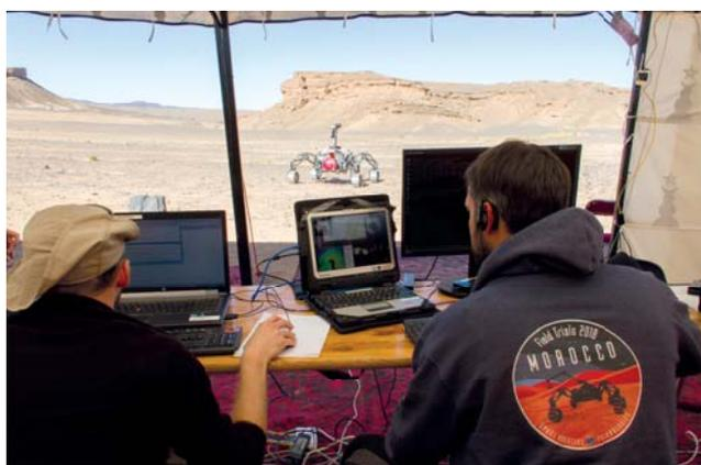
Der DFKI-Rover SherpaTT durchquerte dank neuer Software autonom die marokkanische Wüste und legte dabei eine Strecke von über 1,3 km zurück.
