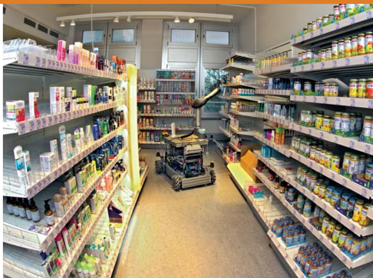
Das Robotersystem Donbot greift in einer nachgebauten Einzelhandelsfiliale am Institut für Künstliche Intelligenz (IAI) der Universität Bremen in ein Regal.
