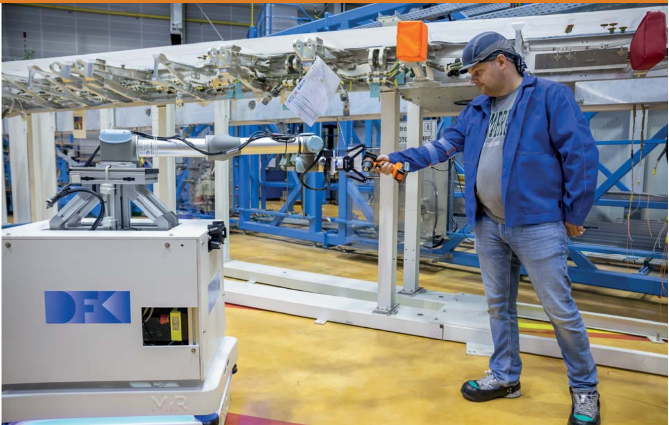
Der mobile Manipulator Mobipick reicht im Rahmen des Projekts Hybr-iT zur verbesserten Mensch-Roboter-Kollaboration in einer Werkstatt von Airbus einem Werker einen Akkuschrauber.
