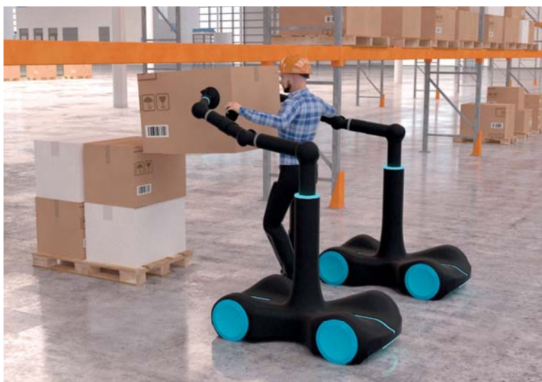
Im Projekt KALI werden kraftunterstützende, mobile Systeme entworfen, die bei der manuellen Handhabung von unterschiedlichen Gegenständen in der Logistik die körperliche Belastung reduzieren und Prozesse effizienter gestalten.
